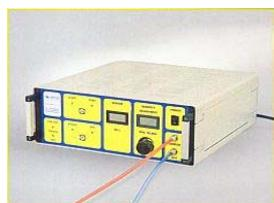
Предназначен для использования аргона, SF6 либо других инертных газов, с возможностью подключения 2-х типов газов одновременно. Процесс автоматический. Скорость заполнения - до 8 л\мин, регулируемая и контролируется с помощью дисплея. Звуковая сигнализация окончания процесса. 220В\50Гц, 40Вт; 2,5атм, 450x150x370мм; вес - 10кг
