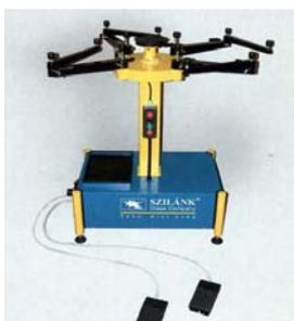
**Модель Sealtable-A** – с автоматическим приводом вращения и фиксации стеклопакета. 2 режима вращения. Макс. размер стеклопакета – 1800x1800мм. 380В/50Гц, 0,2кВт, 7атм. Вес – 80кг.
