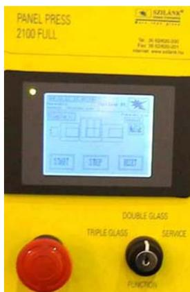
Панельный пресс автоматически распознает толщину стеклопакета и наличие стекла в машине. Управление прессом осуществляется с помощью дисплея touch-screen.
