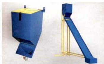
Механическое приспособление для одновременного заполнения влагопоглотителем заготовок распорной полосы всех сторон периметра стеклопакета. Настольное и напольное исполнение.
