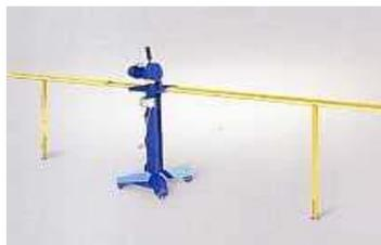
Пила снабжена специальным диском для резки распорной полосы и декоративных панелей (5,5–23,5мм); укомплектована станиной, зажимом (управляется педалью), поддерживающим устройством (2x1850мм). с линейкой и упорами. 220В/50Гц, 0,25кВт. Габариты: 540x540x1000мм, вес – 25кг.
