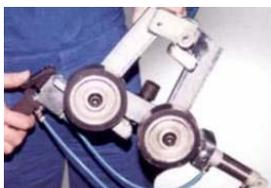
Опрессовка периметра стеклопакета выполняется с использованием вертикального пресса, если таковой имеется в комплектации линии (см. выше), либо с помощью ручного пневматического пресса. 5атм, вес – 4,5кг.
