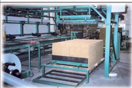
Специально изготавливается для автоматической загрузки предварительно нарезанных ламелей с паллет либо цельных минеральных плит типа Rockwool Conrock.
