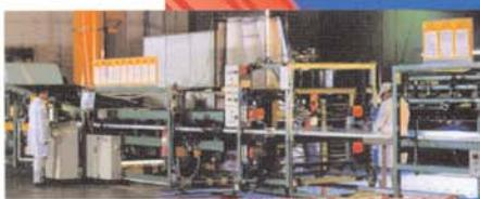
Процесс производства является непрерывным, обеспечивая производство не менее 1000 пог\м панелей в смену с различными типами наполнителя (минеральная вата, пенополистирол, и т.д.) и замковых соединений.
