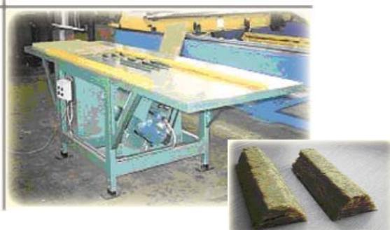
Для изготовления трапециевидных ламелей, используемых для укладки в гофры глубокопрофилированных кровельных панелей типа Trideck, дополнительно используется пила специальной конструкции
